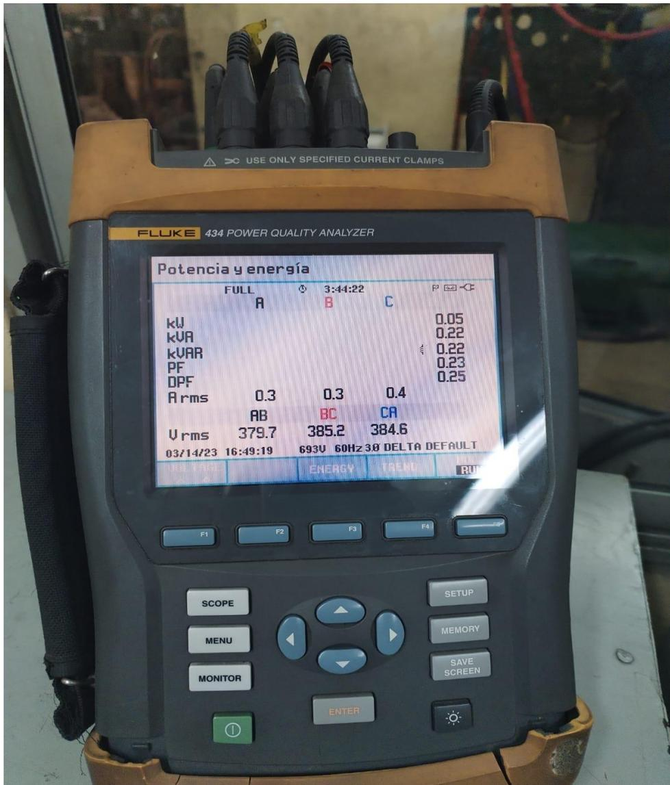
Figura 6.15. Se mide el voltaje que se envía al control del regulador de voltaje, el cual es 380VAC aproximadamente.
