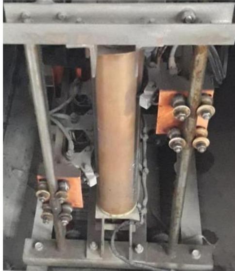
Figura 6.1. Adquisición de autotransformador variable (VARIAC) de un laboratorio.
