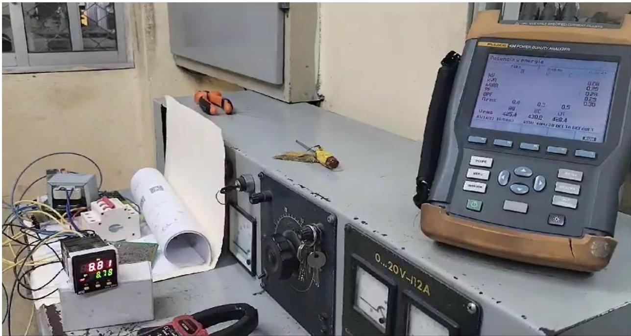
Figura 6.16. Prueba de la respuesta del regulador ante variación elevadas en el voltaje de entrada, se observa que un incremento de 430VAC mientras que el voltaje de salida es de 380VAC aproximadamente como lo indica el controlador.
