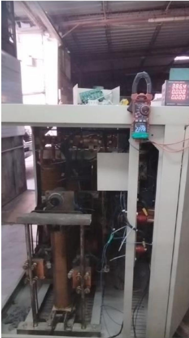
**Figura 6.19. Prueba con todas las etapas interconectadas, por medio del suministro del laboratorio de la empresa se realizan fluctuaciones de voltaje reales y se observa la regulación efectiva, en el caso se tiene un voltaje 222.8VAC del multímetro y desde un medidor externo se mide 386.4VAC línea en la salida del regulador, se puede ver como las escobillas se encuentran separadas por una distancia equivalente al voltaje sustraído.**
