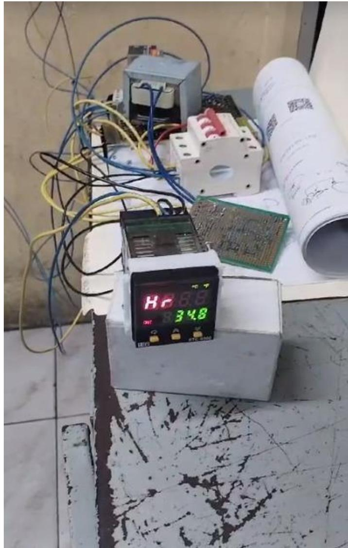
**Figura 6.14. Prueba del transductor de tensión con controlador ante variaciones controladas de voltaje alrededor del punto de operación 380VAC.**
