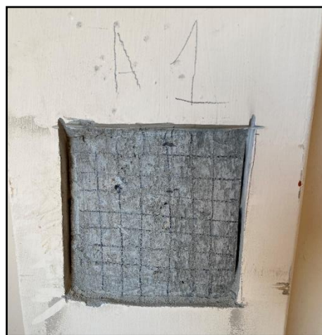
Ilustración 2. 5 Preparación de superficie para el ensayo Esclerométrico (Rivera J., 2024)
