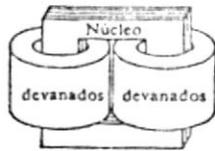
FIG. 1. Transformador tipo núcleo
