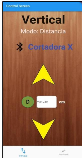
En la Figura 3.30 se observa la interfaz de la aplicación en modo distancia, que controla los movimientos de cortes verticales dependiendo de los centímetros colocados por el usuario
