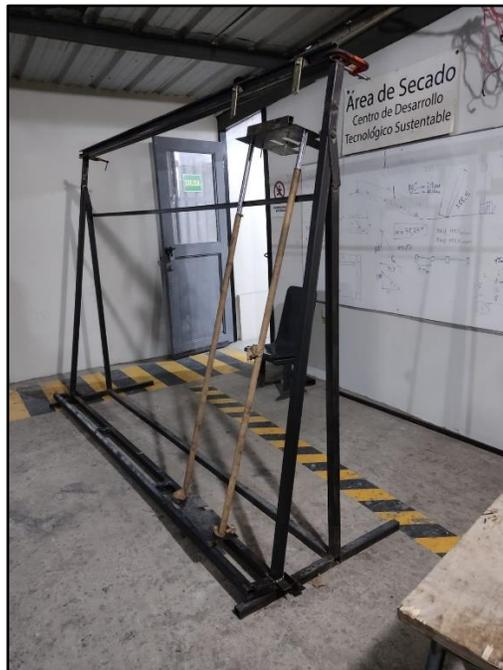
En la Figura E.8 se observa que se completó el 100% de la soldadura, es posible afirmar que la seccionadora vertical puede admitir paneles de hasta 2438 x 1219 mm y tiene 3 metros de ancho.
