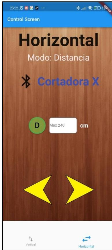
En la Figura 3.31 se observa la interfaz de la aplicación en modo distancia, que controla los movimientos de cortes horizontales dependiendo de los centímetros colocados por el usuario
