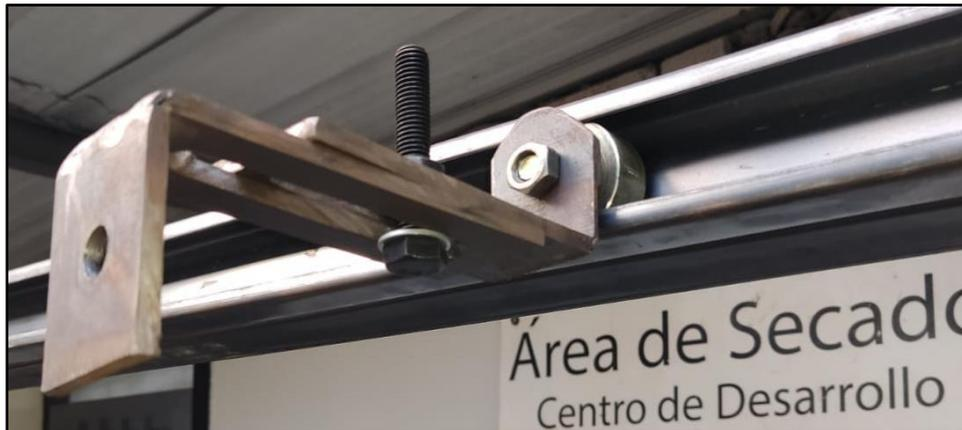
En el desarrollo de la implementación se realizó un sistema de ojos chinos, tanto en el rodamiento aéreo (Figura 3.24) como en la placa superior (Figura 3.25), para que el sistema móvil esté paralelo con la cama de la cortadora, con el fin de que la sierra circular tenga la misma profundidad a lo largo del camino. El paralelismo entre la cama y el sistema móvil se obtiene regulando el grado de inclinación lo cual es posible por el ojo chino.
