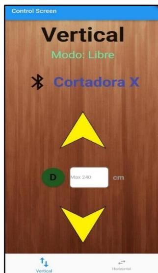
En la Figura 3.28 se muestra la interfaz de la aplicación cuando el usuario selecciona los cortes verticales y se encuentra en modo libre, en este modo el usuario no puede escribir los centímetros a cortar, garantizando que el usuario no digite algún número por error. El mismo funcionamiento se aplica para el modo horizontal mostrado en la Figura 3.29.
