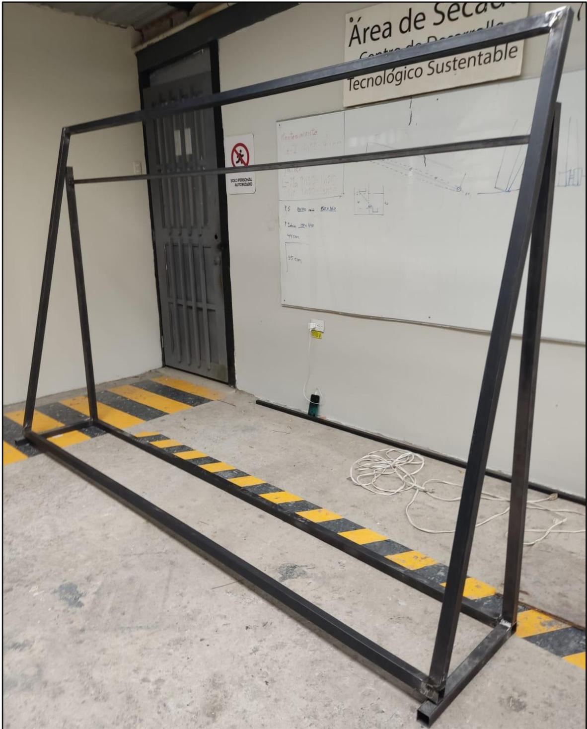
La dificultad de fabricación de la base es baja, lo que toma más tiempo es la soldadura que se debe hacer en cada punto de contacto, ya que se debe garantizar la rigidez de la base. Para realizar la soldadura de la cama se necesitó de bastante tiempo, cortar los tubos, soldar, etc.
