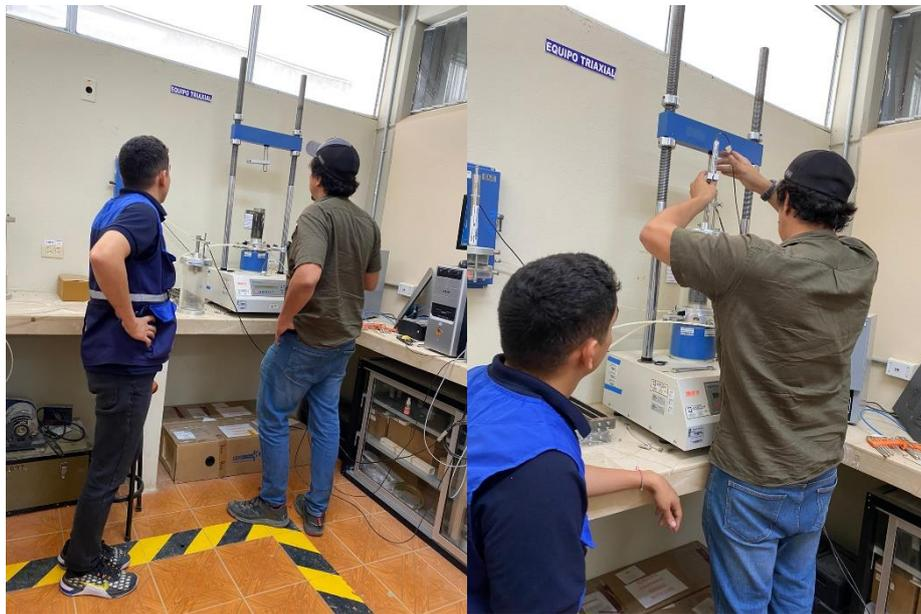
*Imagen 2.22 Ajuste de transductores de cámara triaxial. (Morales & Taipe, 2022)*
