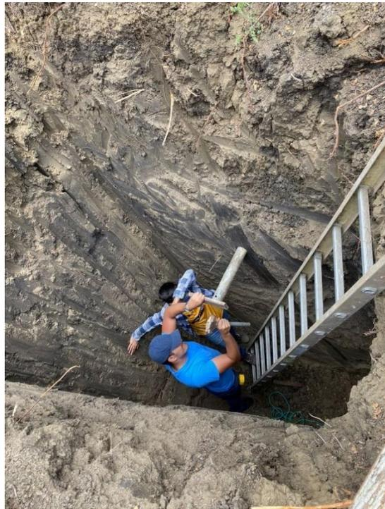
*Imagen 2.9 Preparación de muestra para ensayos. (Morales & Taipe, 2022)*
