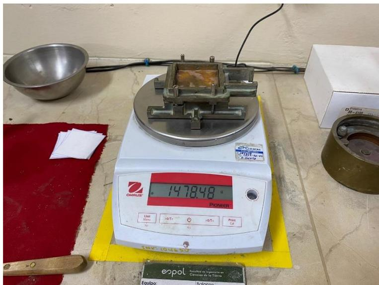
Imagen 2.20 Muestras de suelo utilizadas para determinar límite plástico. (Morales & Taipe, 2022)
