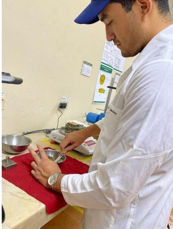
Imagen 2.19 Muestras de suelo utilizadas para determinar límite plástico. (Mortales & Taipe, 2022)
