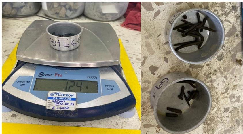
Imagen 2.18 Muestras de suelo utilizadas para determinar límite plástico. (Morales & Taipe, 2022)
