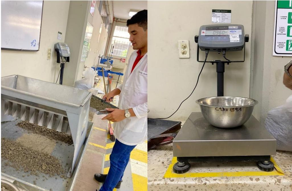
Imagen 2.15 Cuarteo de muestra para ensayos. (Morales & Taipe, 2022)
