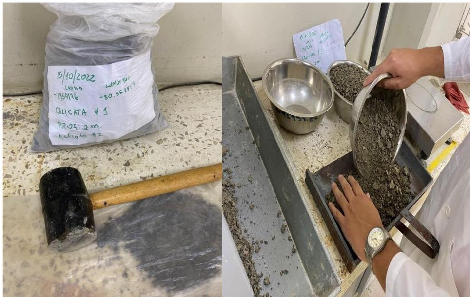
Imagen 2.14 Preparación de muestra para ensayos. (Morales & Taipe, 2022)
