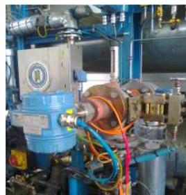
**FIGURA 4.2 CONTROLADOR DE TEMPERATURA DEL COMBUSTIBLE.**
