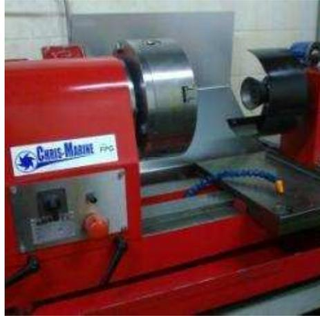
**FIGURA 4.3 MÁQUINA LAPEADORA DE INYECTORES.**
