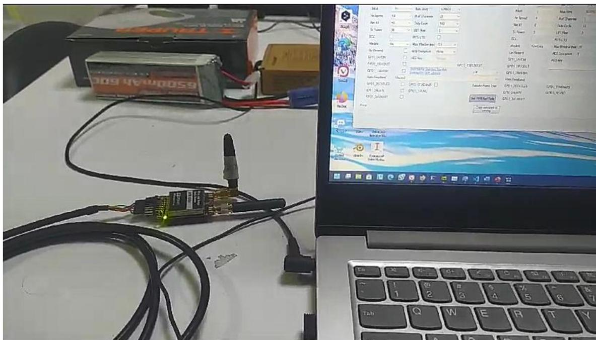
Para usar dos módulos de radiofrecuencia en una misma red, es necesario configurar cada módulo con la misma velocidad de transmisión en baudios, la velocidad en aire, el identificador
