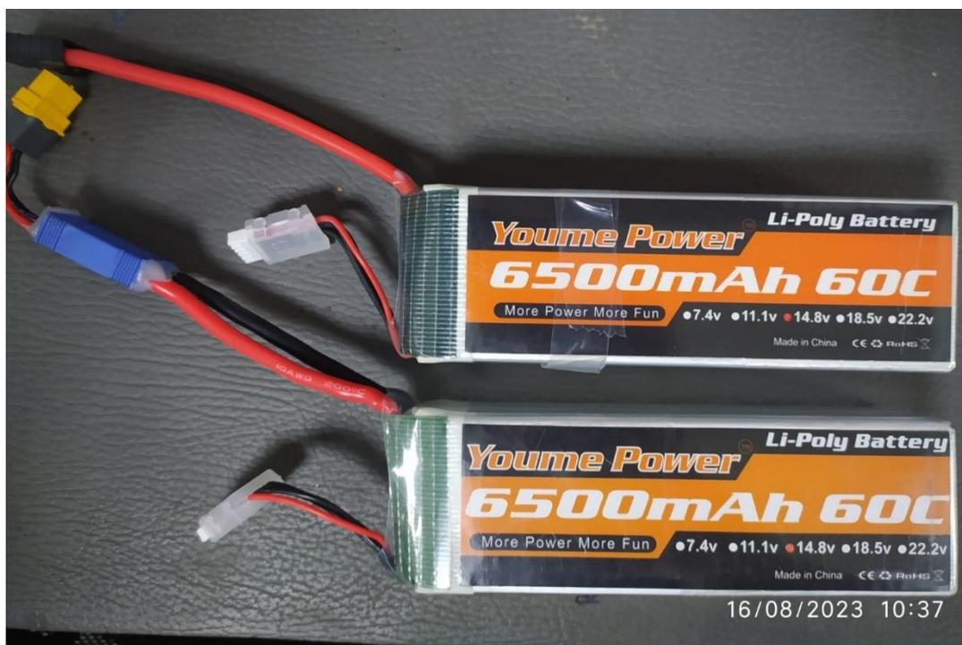
Finalmente, dentro de las baterías que el cliente puso a disposición, existen dos baterías del tipo que fue preseleccionada, de 14.8 V con 6,500 mAh de capacidad, mostradas en la Figura 2.8. Dada su relativamente baja masa, de 590 g, es posible colocar las dos baterías en la embarcación y conectarlas en paralelo, para alcanzar los 13,000 mAh. Brindando 192 W, que bastarían para más de 50 minutos de autonomía.
