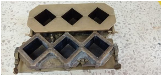
Moldes para cubos de mortero
