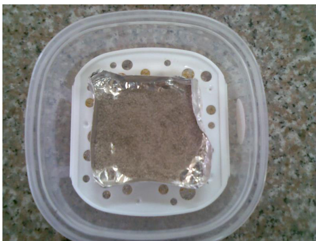
Figura 3.2 Sistema elaborado para realizar la isoterma de Sorción del camote.
