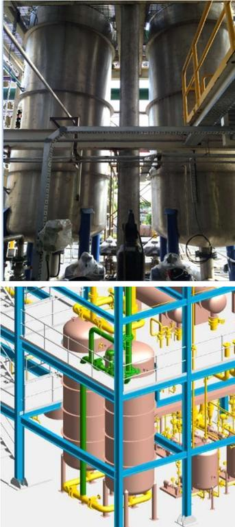
**FILTROS MOLECULARES.-** En esta operación, la mezcla etanol-agua pasa a través de los tamices moleculares que contiene un lecho de material adsorbente. Quedando el agua atrapada en el lecho a través de fenómenos de transporte superficial, mientras el etanol pasa a través de este aumentando su concentración.
