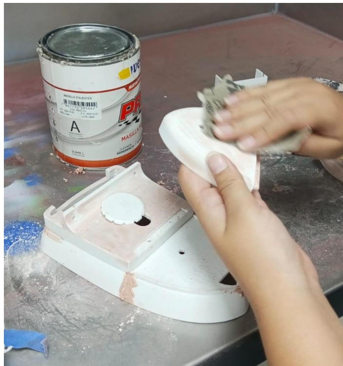
Figura 4.6.2 Masillado y lijado de cada pieza del producto.
