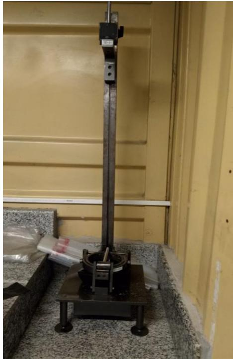
Asimismo, la prueba de tracción, basada en la norma ASTM F88, que analizó la resistencia de las áreas selladas bajo tensión. Se realizaron 5 mediciones en los sellos del asa y 5 mediciones en los sellos del fondo por cada condición experimental en el equipo de dinamómetro digital marca IMADA, como se observa en la figura 2-8.
