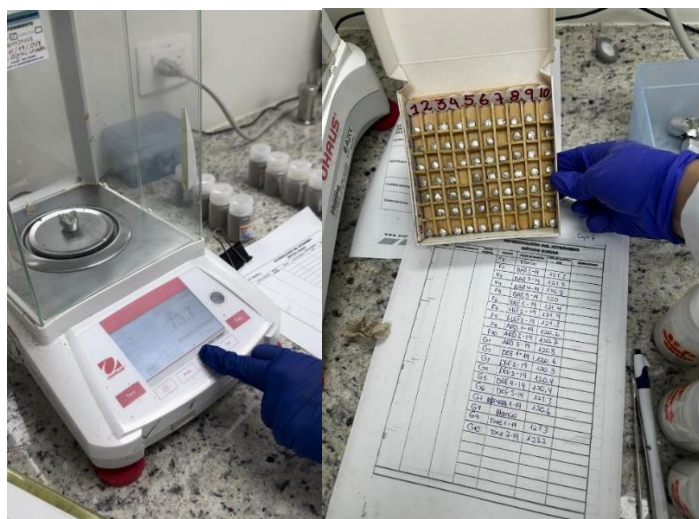
Ilustración 11. Proceso de preparación de muestras para medición en el equipo Elemental
