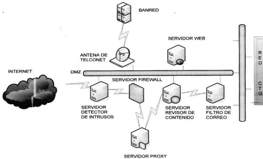
Figura. 2.5 Esquema Propuesto de Seguridad en la Red<sup>17</sup>
