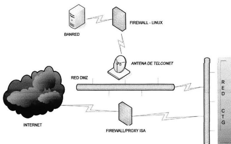
Figura 1.3 Esquema General Actual de la Seguridad en la Red de la CTG<sup>4</sup>
