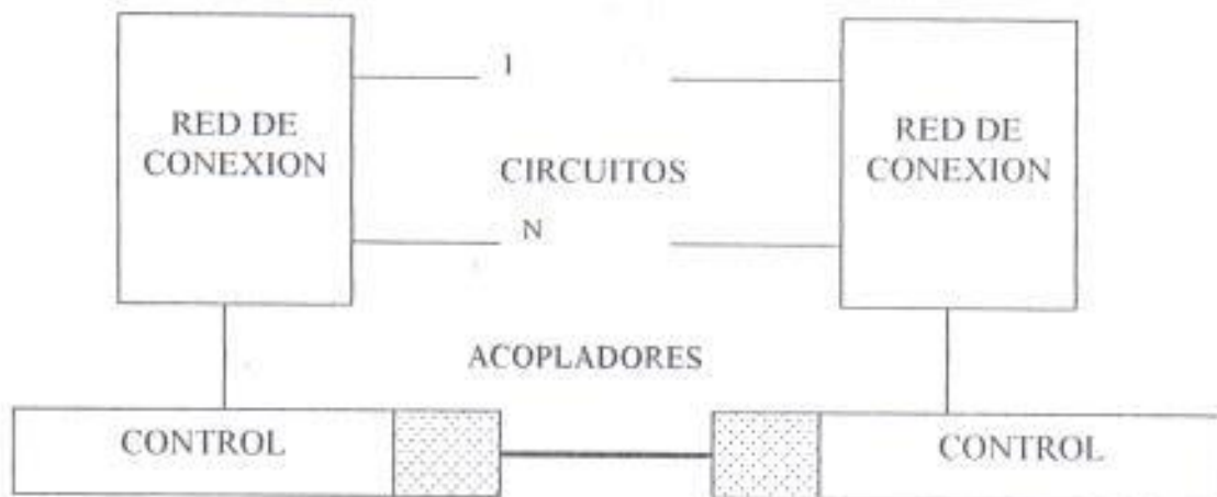
Señalización por canal semáforo
