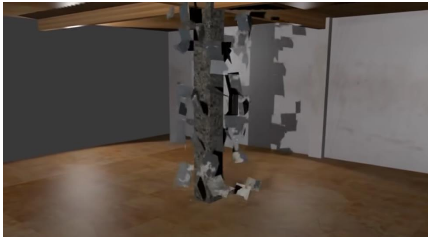
Gráfico 3.18: Retiramiento de la capa de recubrimiento.
