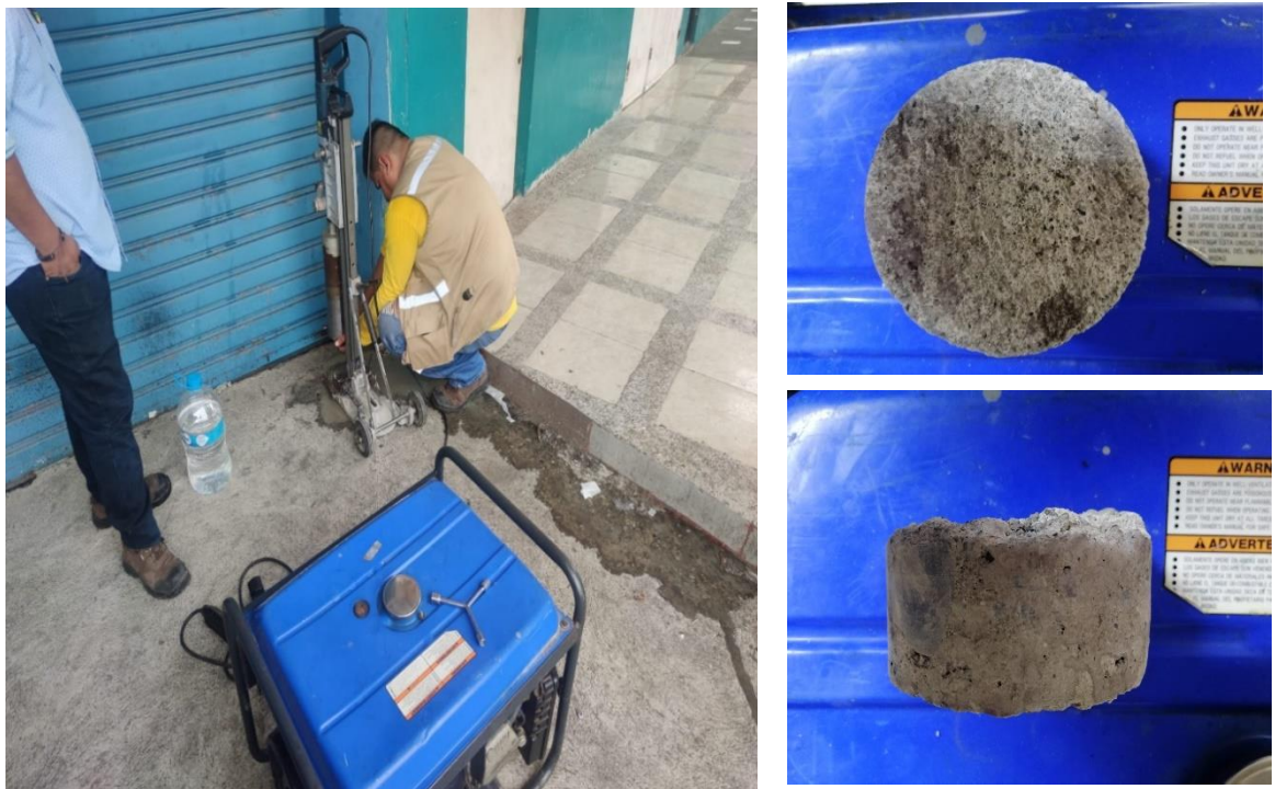
Gráfico 2.9: Extracción de núcleo correspondiente a la Planta Baja
