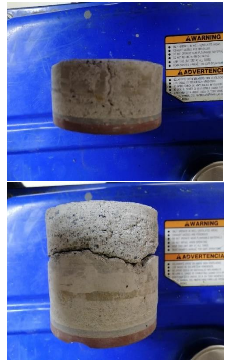
Gráfico 2.10: Extracción de núcleo correspondiente a la Primera Planta Alta
