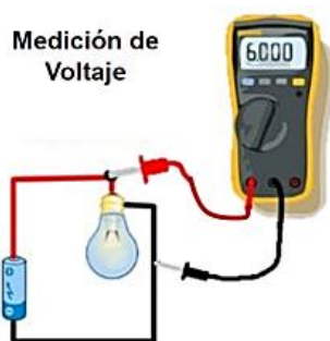
Figura 2.11: Medición de Diferencia de Potencial
