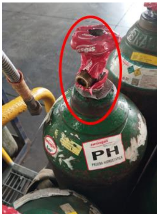
Figura 32 Defectos en el envase
