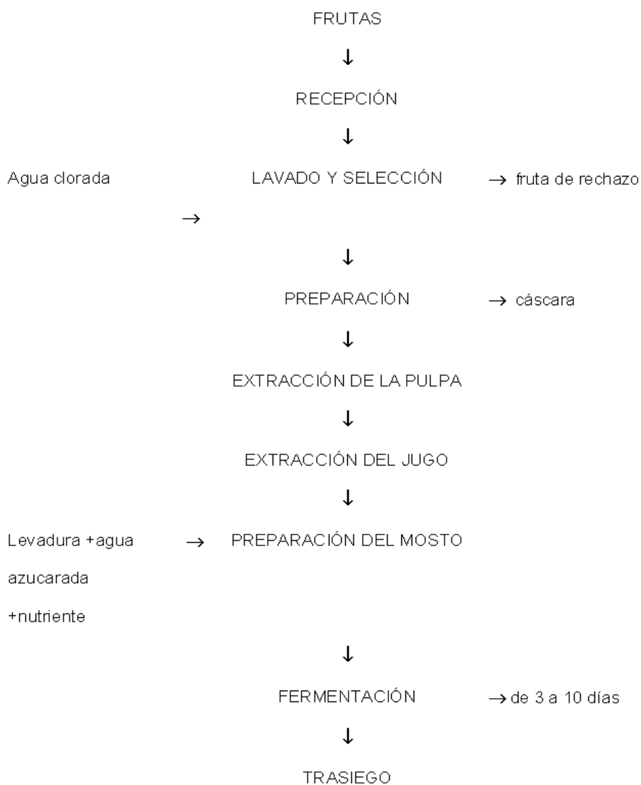
Diagrama No. 2 Flujo para la elaboración del vino de naranja San Marcos
