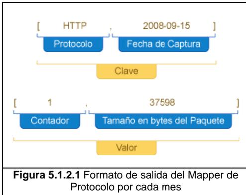
**Figura 5.1.2.1** Formato de salida del Mapper de Protocolo por cada mes
