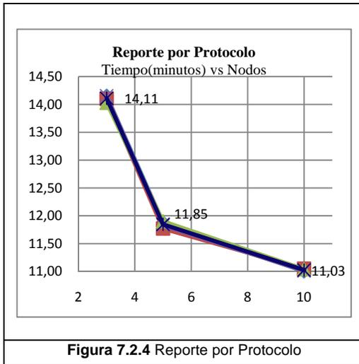
Como se muestra en la Figura 7.2.4, se realizaron tres pruebas de procesamiento masivo para el Reporte por Protocolo, teniendo una diferencia de tiempo dentro de un intervalo de +/- 10 seg. Con tres nodos se obtuvo un tiempo de procesamiento de 12,67 seg., en cambio con cinco nodos se obtuvo un tiempo de procesamiento de 10,82 seg., mientras que con diez nodos se obtuvo un tiempo de procesamiento de 10,45 seg.
