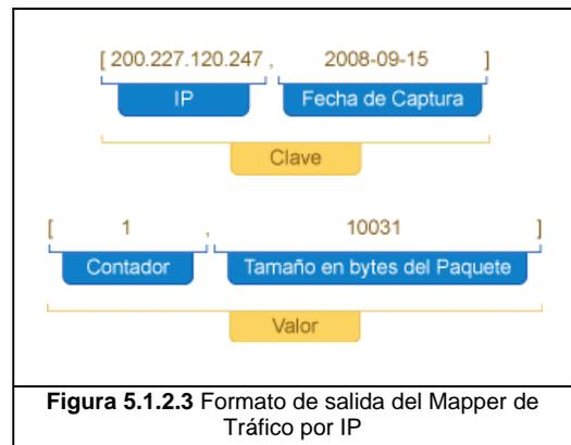
**Figura 5.1.2.3** Formato de salida del Mapper de Tráfico por IP
