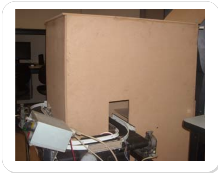
Figura 4- 3 Armario de Iluminación
