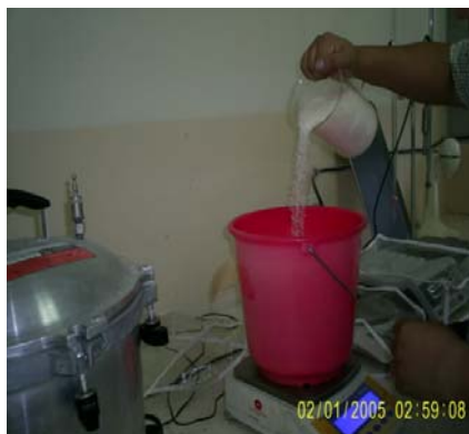
FIGURA 3.16 PESADO DEL HDPE
