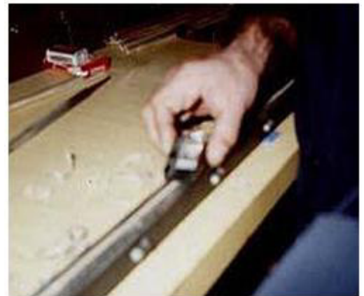
Figura 2.3. Cepillado de la madera.
