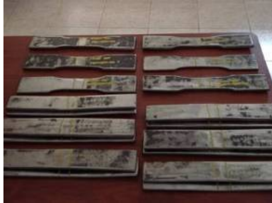
Figura 4.10 Especímenes para obtener probetas para ensayos de tracción y dobléz
