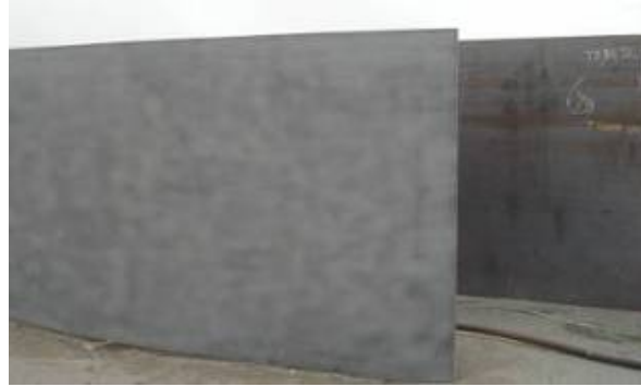
Figura 4.21 Superficies antes y después de sp10 (anillo)
