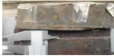
Figura 4.16 Rotura de la junta – penetración del filete
