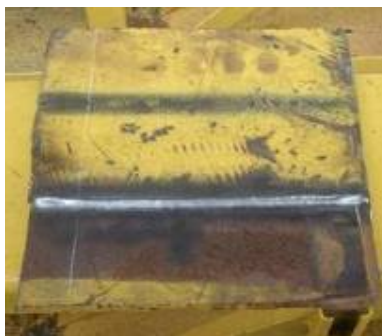
Figura 4.5 Cupón de prueba filete – Traslape SMAW
