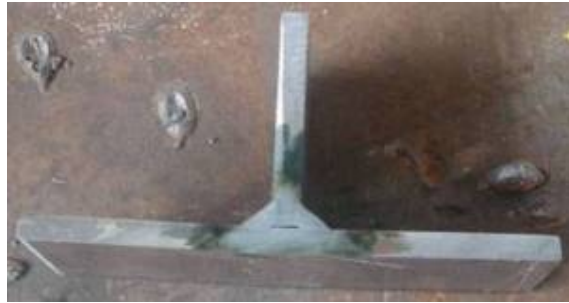
Figura 4.13 (a) Especimen de Prueba para macrografía de placas
