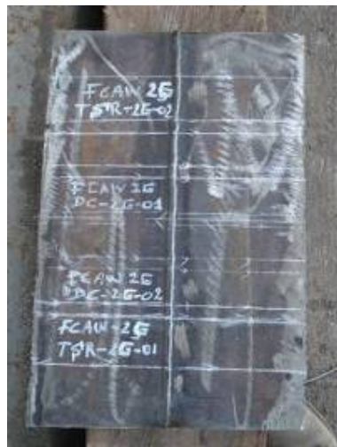
Figura 4.7 Cupón de prueba – FCAW 2G
