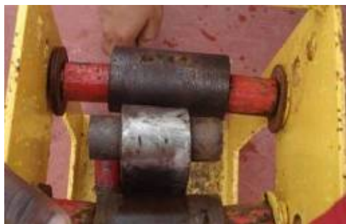
Figura 4.15 Prueba de dobléz – junta a tope
