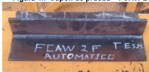
Figura 4.8 Cupón de prueba doble filete – FCAW
