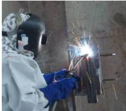
Figura 4.6 Cupón de prueba – FCAW 3G
