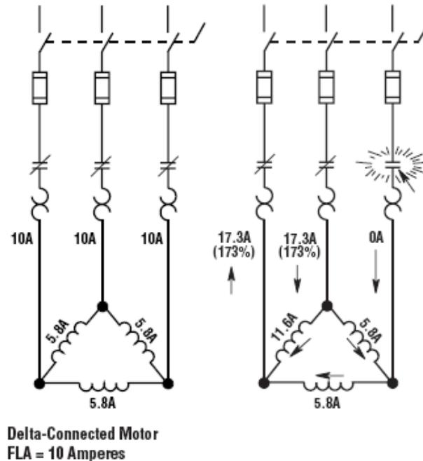
**Fig. 3.8. Operación del motor bajo falla monofásica.**
