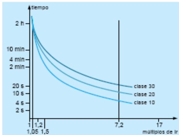
**Fig. 3.11. Curvas de las clases de Relé térmico.**
