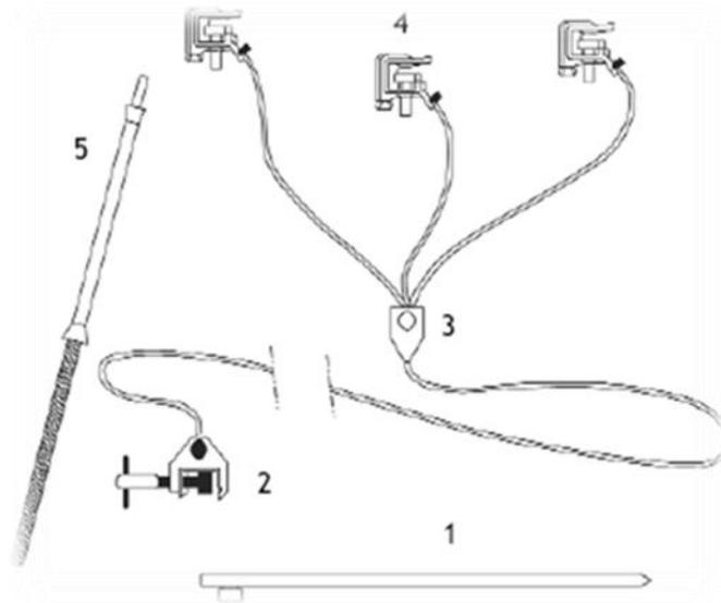
**Fig. 5.7. Elementos de un equipo portátil de puesta a tierra.**
