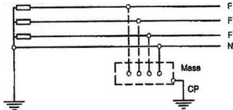
**Fig. 2.10. Esquema TT.**
