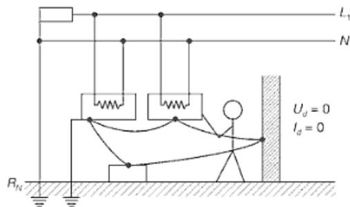
**Fig. 4.7. Conexión equipotencial de las masas.**
