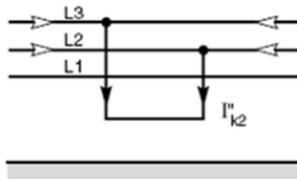
**Fig. 2.2a. Cortocircuito bifásico aislado.**
