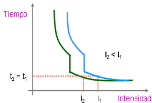
**Fig. 3.6. Selectividad Amperimétrica.** (Fuente: <http://www.tuveras.com/aparamenta/magnetotermico.htm>)
