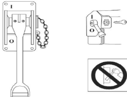
**Fig. 5.2. Inmovilización del aparato de maniobra.**
