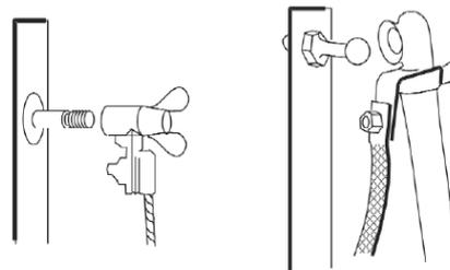
**Fig. 5.8. Puntos fijos de puesta a tierra.**
