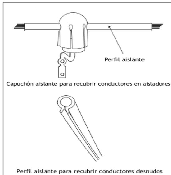
**Fig. 5.13. Materiales utilizados en el método de trabajo en contacto. (Fuente: Guía Técnica para la Evaluación y Prevención de Riesgo Eléctrico)**
