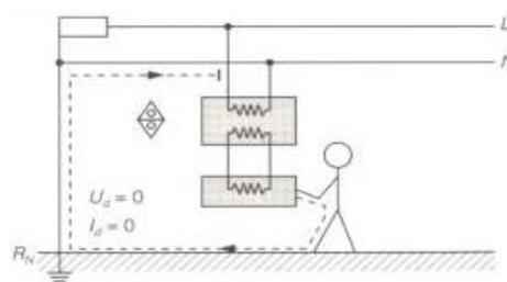
**Fig. 4.4. Separación de circuitos.**
