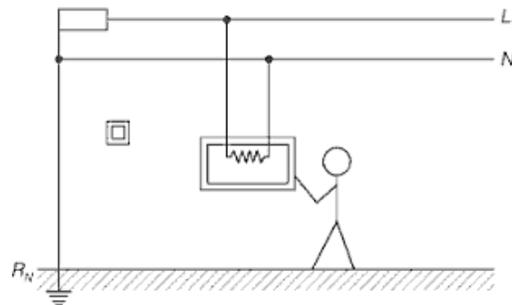
**Fig. 4.6. Separación de las partes activas.**
