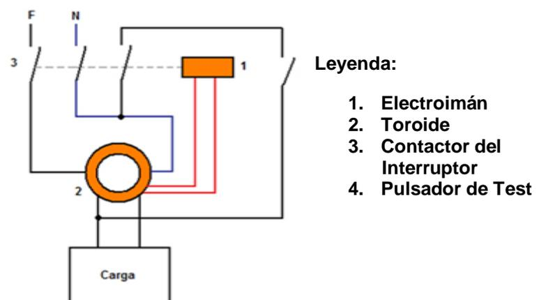
**Fig. 3.9. Esquema interno de un interruptor diferencial.**
