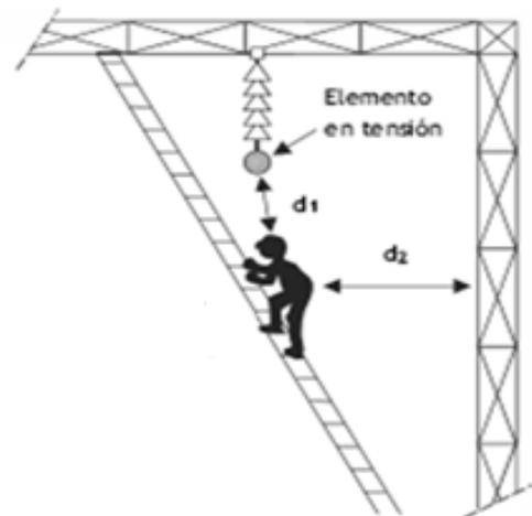
**Fig. 5.11. Método de trabajo a potencial.**
