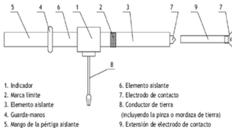
**Fig. 5.5b. Detector de tensión tipo resistivo para AT.**
