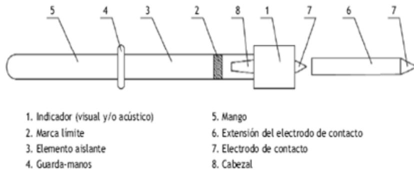
**Fig. 5.5a. Detector de tensión tipo capacitivo para AT.**
