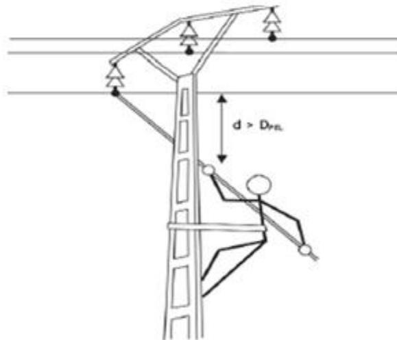
**Fig. 5.12. Método de trabajo a distancia.**
