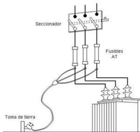
**Fig. 5.9. Puesta a tierra de un circuito de alta tensión.**
