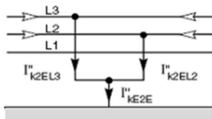
**Fig. 2.2b. Cortocircuito bifásico a tierra.**
