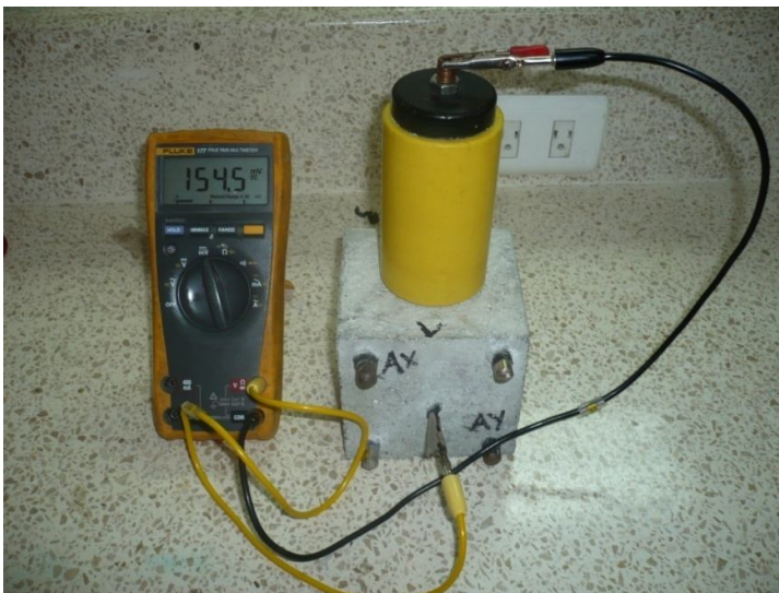
Fig. 4.- Medición de potencial contra el electrodo CSC
