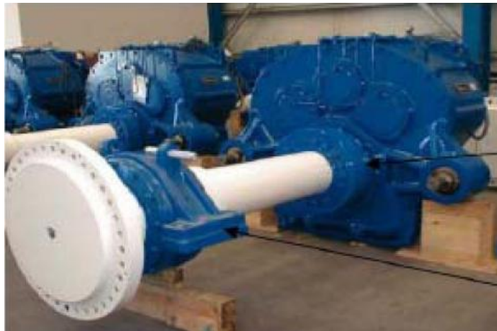
Gráfica No. 43 : Eje de baja velocidad de una aeroturbina.
