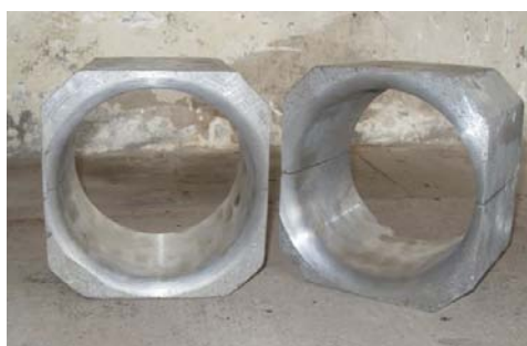
FIGURA 2.5. COJINETES ANTES Y DESPUES DE SER MAQUINADOS
