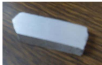
FIGURA 2.3.B) PROBETA PARA ENSAYO DE DUREZA
