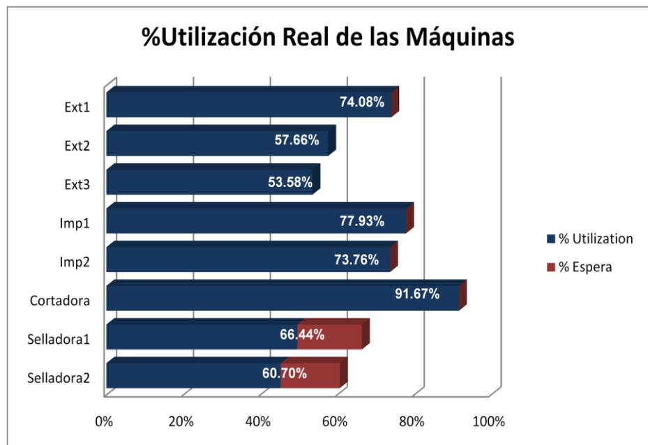
**Gráfico 5.11. Utilización Real de las máquinas en el modelo mejorado**
