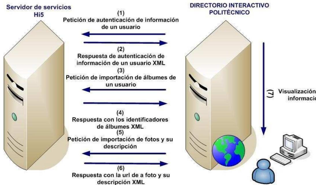
Figura 7.- Diagrama de comunicación REST con el servicio web de Hi5
