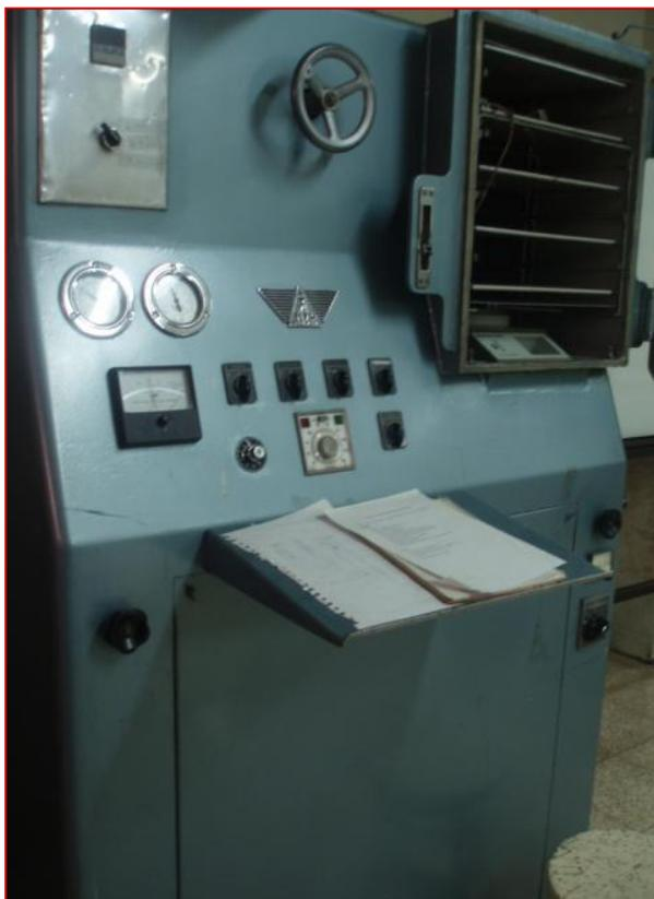
**Fig. 2.6. Equipo piloto de liofilización**
