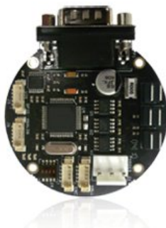
Figura 3. Round Mercury es un controlador de motor en lazo cerrado para motores DC y brushless de 400W
