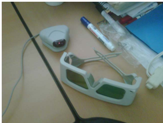
Fig. 36: Gafas estereoscópicas con su sensor
