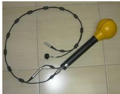
Figura 3.5 Antena Triaxial del SRM 3000, con cable adaptador RF. 36
