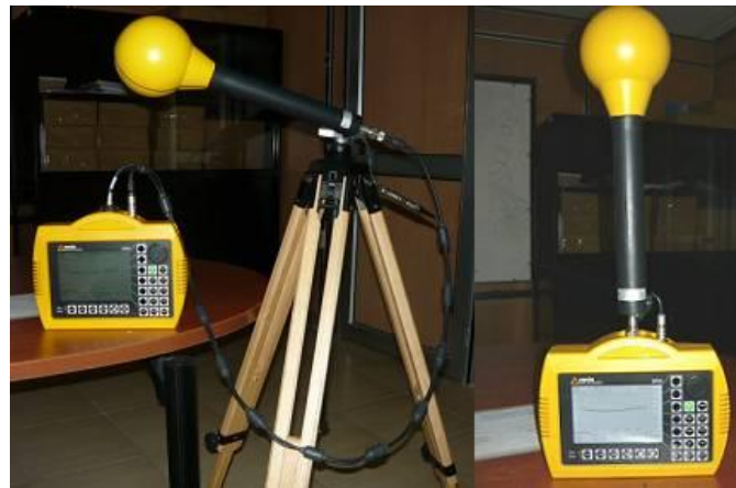
Figura 3.3 Representación la instrumentación de medición 1 con el equipo NARDA SRM 3000. 34
