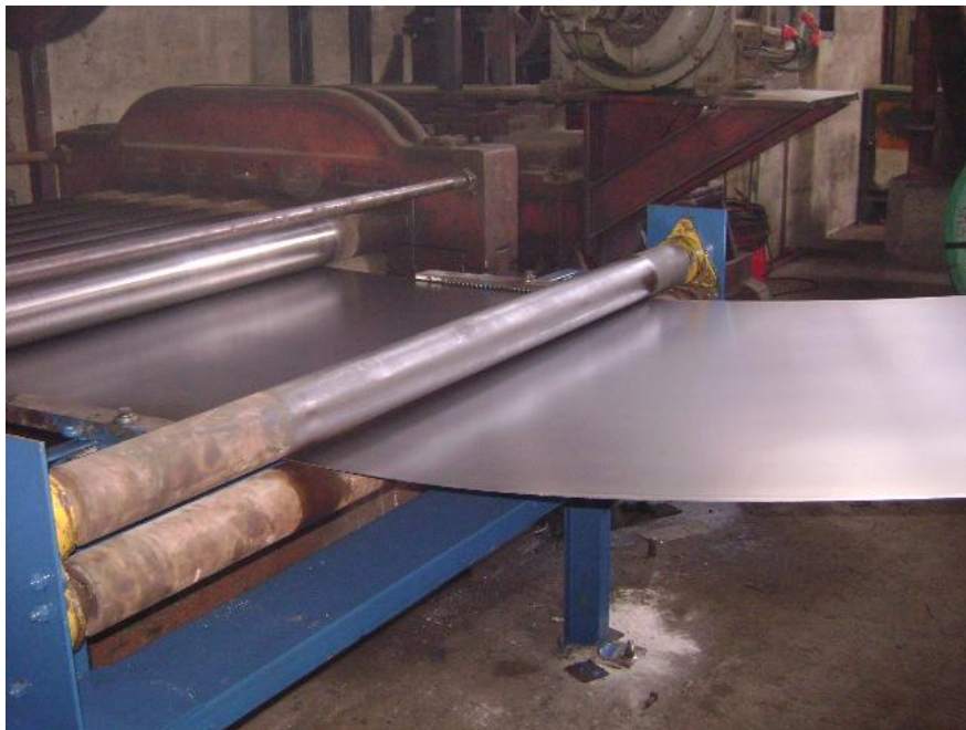
FIGURA 1.30 CHAPA EN FASE DE PLANCHADO
