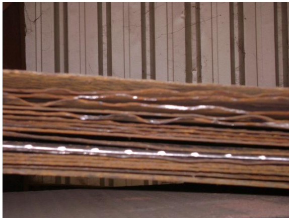
FIGURA 1.23 CHAPAS CON BORDES ONDULADOS
