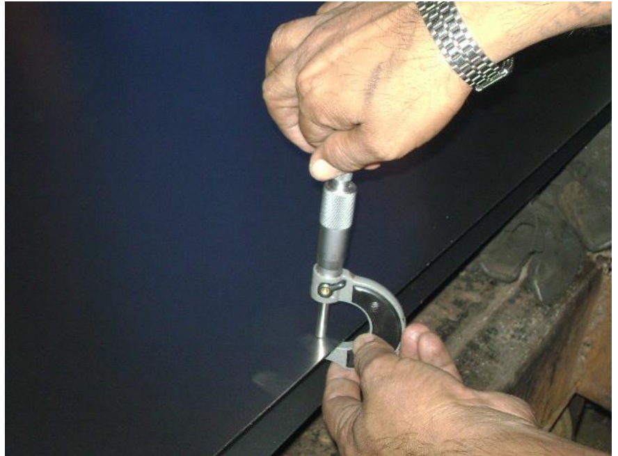
FIGURA 1.15 MEDICIÓN DEL ESPESOR DE LA CHAPA
