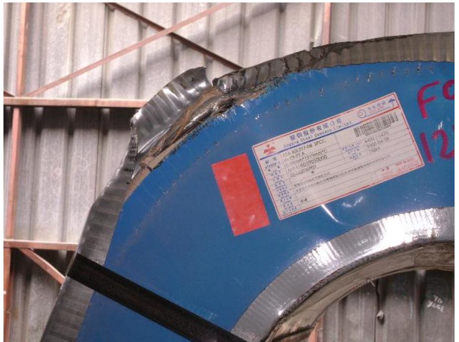
FIGURA 1.14 PROTECCIÓN DE BOBINA DAÑADA
