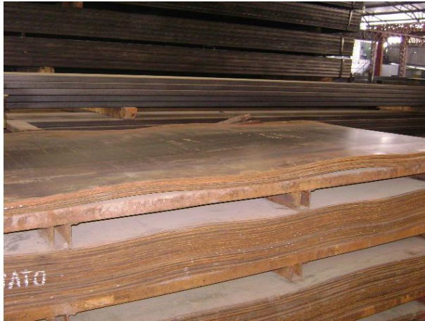
FIGURA 1.21 CHAPAS CON ONDULACIONES SUPERFICIALES
