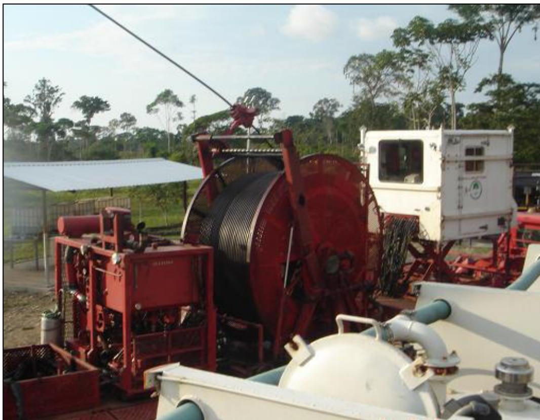
**Fig. III-4** Carrete de Tubing de 3 ½" utilizado y caseta de monitoreo, en la parte inferior y en blanco se encuentra el camión cisterna donde se realiza la mezcla de todos los químicos y aditivos para la inyección. (Cortesía Halliburton Team)
