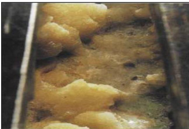
**Fig. I.1** Escala de carbonato de calcio o calcita en las tuberías de producción. (Crabtree et al. 1999). Cortesía de Halliburton.
