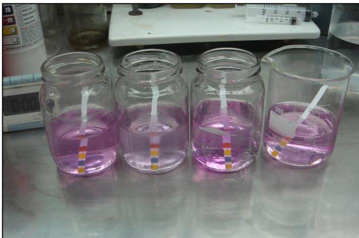
**Fig. III-21** *Titulaciones realizadas con NaOH, se muestra la el papel indicador de pH. (Laboratorio Halliburton). Por José Jines Muñoz*
