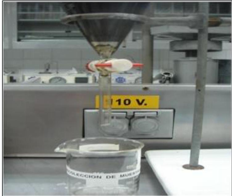
**Fig. III-10** Separación por decantación de las muestras preparadas. (Laboratorio Halliburton). Por José Jines Muñoz
