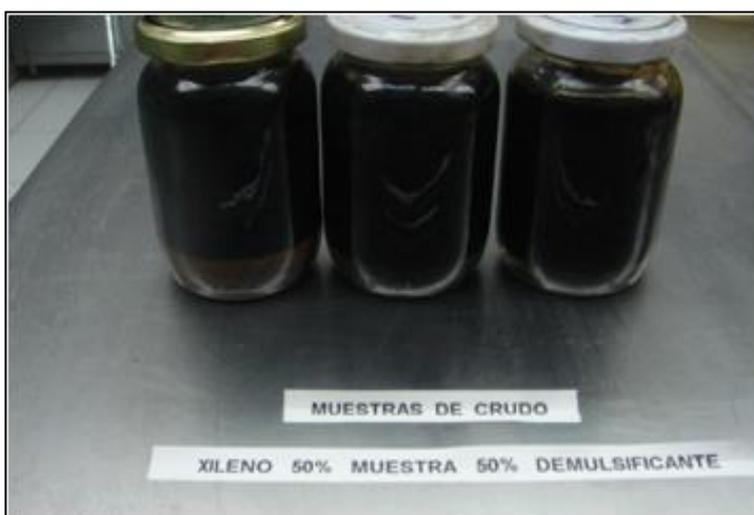
**Fig. III-8** Muestras luego de centrifugación, ya preparadas. (Laboratorio Halliburton). Por José Jines Muñoz
