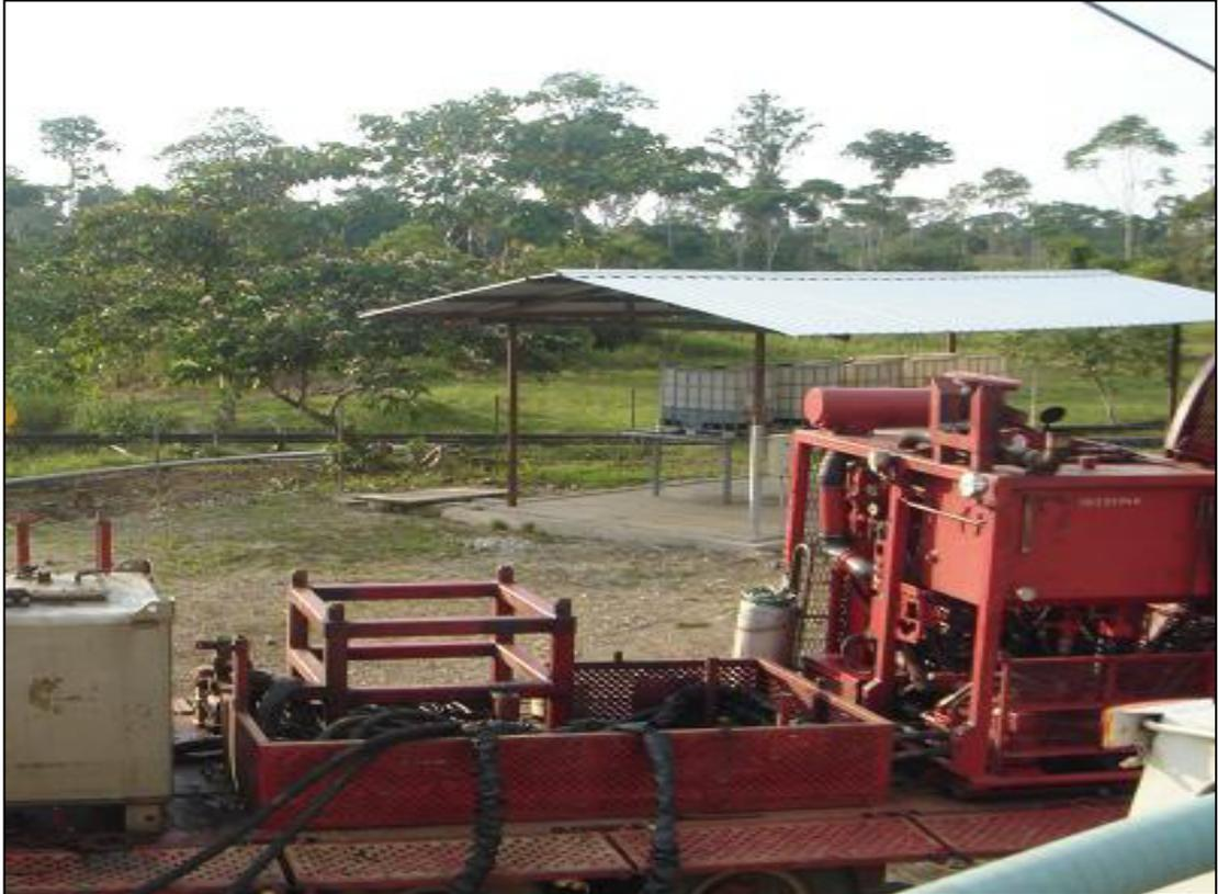
**Fig. III-3** *Unidad de Bombas utilizadas para Inyección de Químico.*
