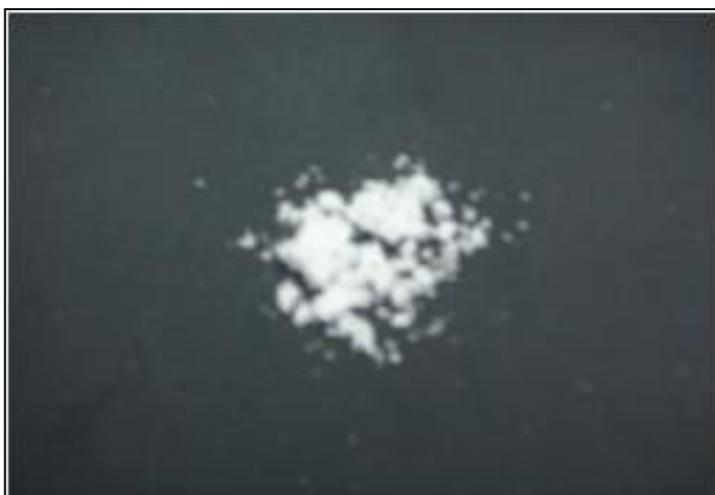
**Fig. III-20** *Precipitado secado, la formación de este sólido en muestras analizadas muestran la carencia a la fecha de antiescala Scalecheck. (Laboratorio Halliburton). Por José Jines Muñoz*
