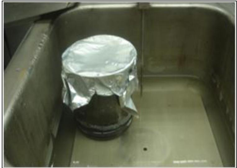
**Fig. III-9** Calentamiento de la muestra en Baño María. (Laboratorio Halliburton). Por José Jines Muñoz
