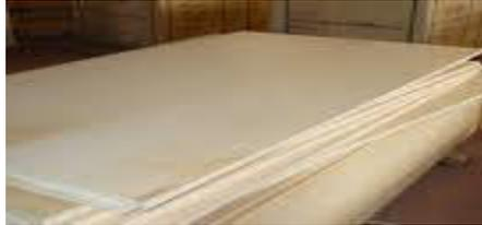
Se puede emplear **Plywood** (madera laminada multicapa) tratado con resinas fenólicas, el cual proporciona una superficie uniforme y casi impermeable. Cuando se desea transferir la veta de la madera al hormigón debe evitarse el empleo de recubrimientos impermeabilizantes. En caso de que se emplee un sellador o impermeabilizante no se debe mezclar diferentes tipos o marcas comerciales. El sopleteado con arena sobre la superficie del plywood proporcionará una textura rugosa al hormigón.
