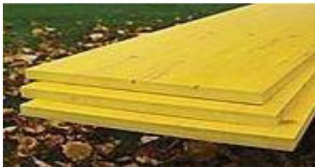
La **madera** es un material para encofrados que se puede emplear con mucha facilidad. Puede tener una superficie lisa, puede estar aserrada con acabado rugoso, o sopleteada con arena para transmitir cierta textura a la superficie del hormigón. Las características de desencofrado dependerán de la clase de madera, del tiempo y las condiciones de exposición durante su almacenamiento, así como de otros factores.
