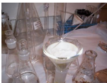
FIGURA 2.19 RECOLECCIÓN DE FASE ORGÁNICA Y ENJUAGUE FINAL CON ETIL ACETATO
