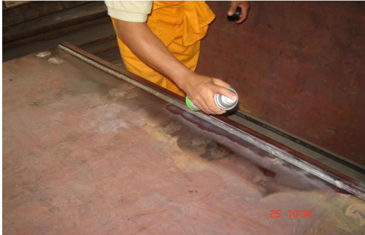
FIG 3.7 ENSAYO POR LIQUIDOS PENETRANTES (APLICACIÓN DEL REVELADOR)
