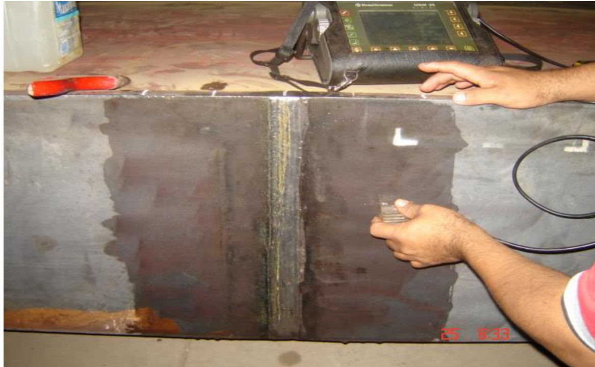
FIG.3.6 ENSAYO POR ULTRASONIDO EN LOS TORNAPUNTAS (SOLDADURA A TOPE)
