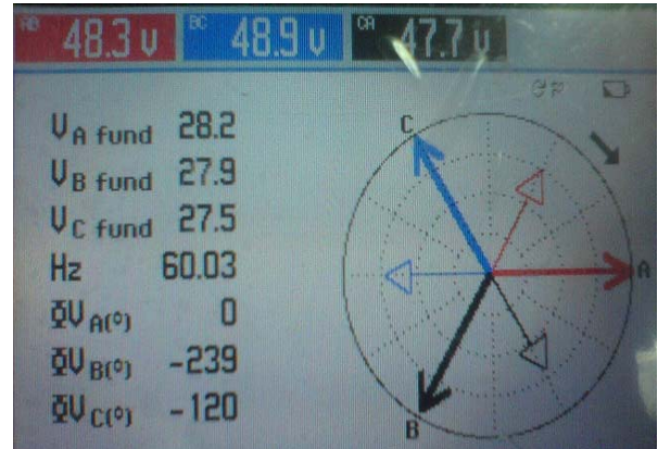
Figura 7.4 Diagrama fasorial de los voltajes de línea-neutro en la carga
