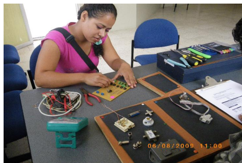
Figura 3-1: Colocando Chips en Sockets.
