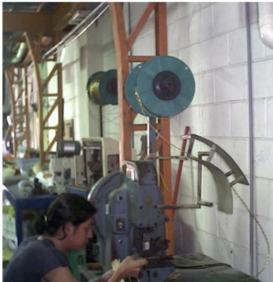
**FIGURA 2.15 REMACHADORA DE TERMINAL FASTON**
