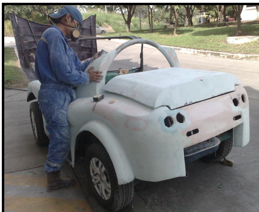
Fig. 9.8: Colocacion de la Masilla Plastica
