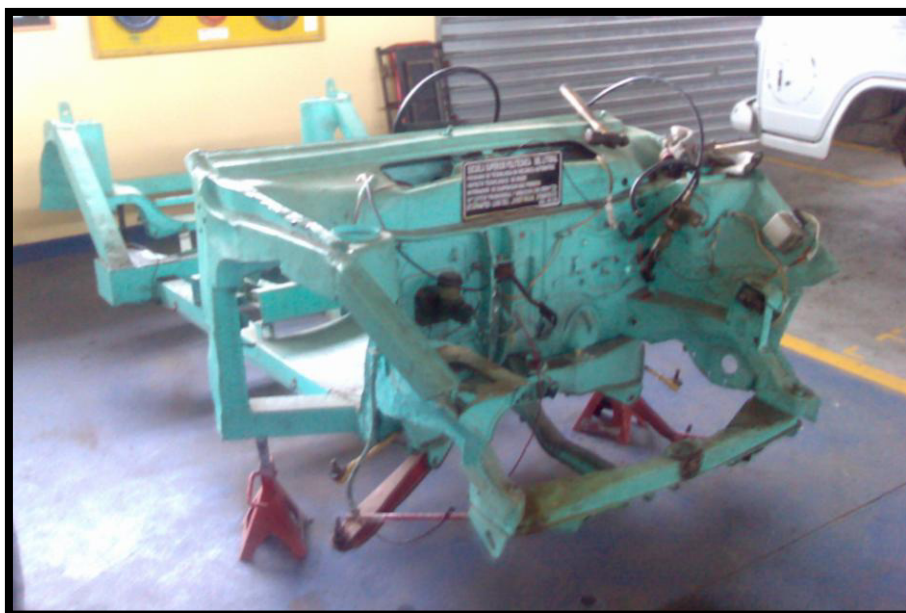
Fig. 9.2: Desmontaje de los sistemas del Vehículo
