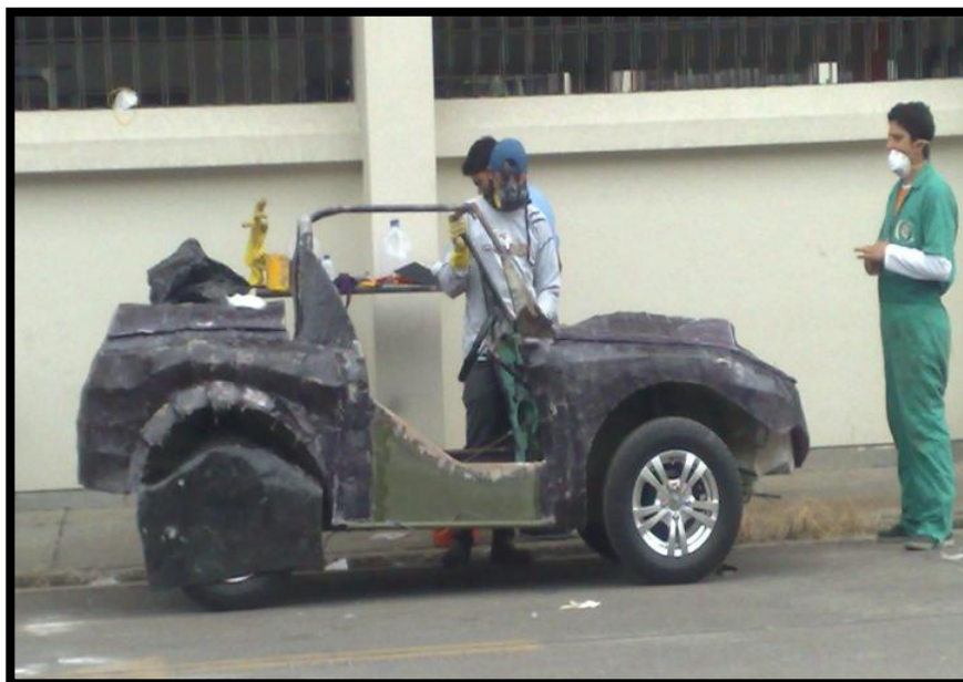
Fig. 9.7. Aplicación de la Fibra de Vidrio y Resina
