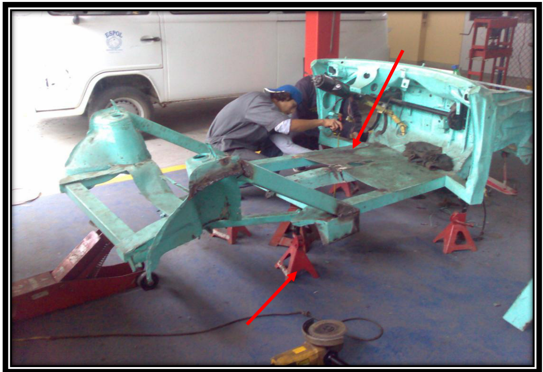
Fig. 2.1 Puntos de Anclaje
