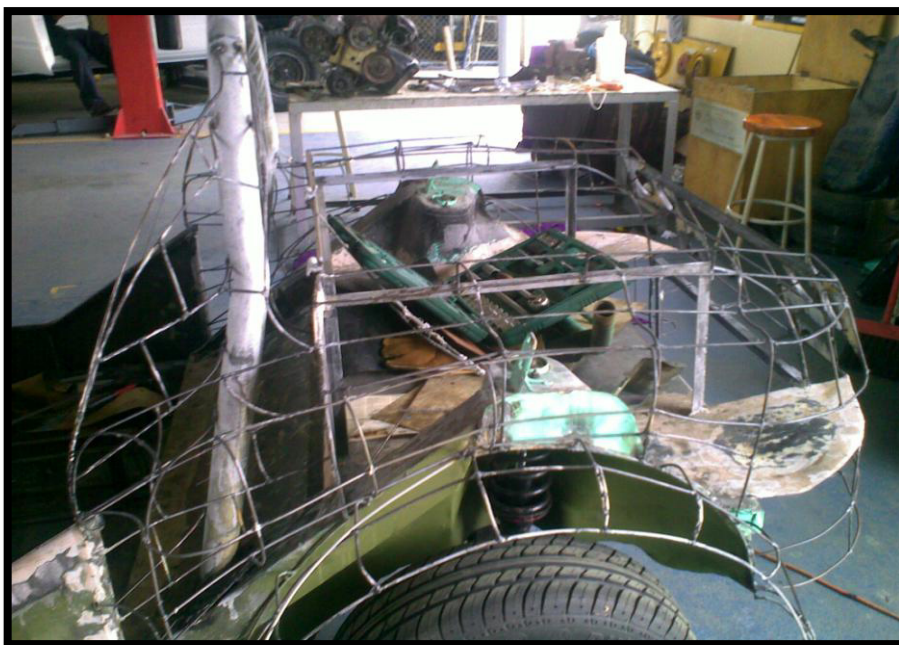
Fig. 9.5. Culminación de la estructura de la Carrocería
