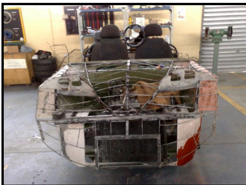
Fig. 9.4: Elaboración de la estructura de la carrocería parte Frontal
