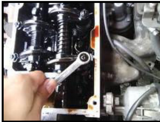
Fig. 3.18 Calibración de Válvulas.
