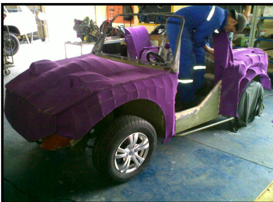
Fig. 9.6. Recubrimiento de la estructura con tela licra Nubeluz
