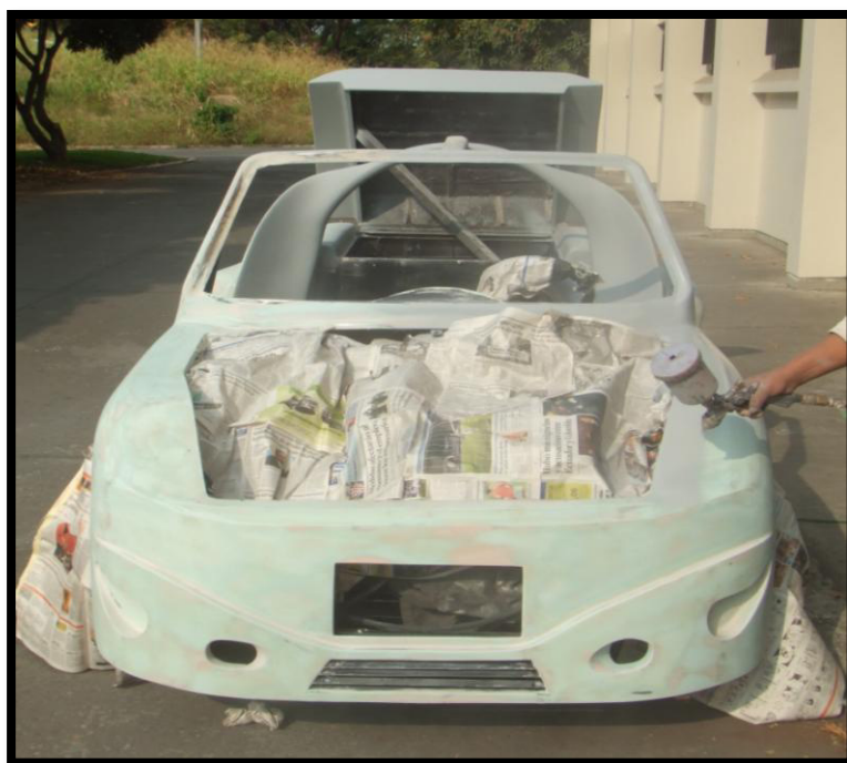
Fig. 9.9. Aplicación del Fondo Glasurit
