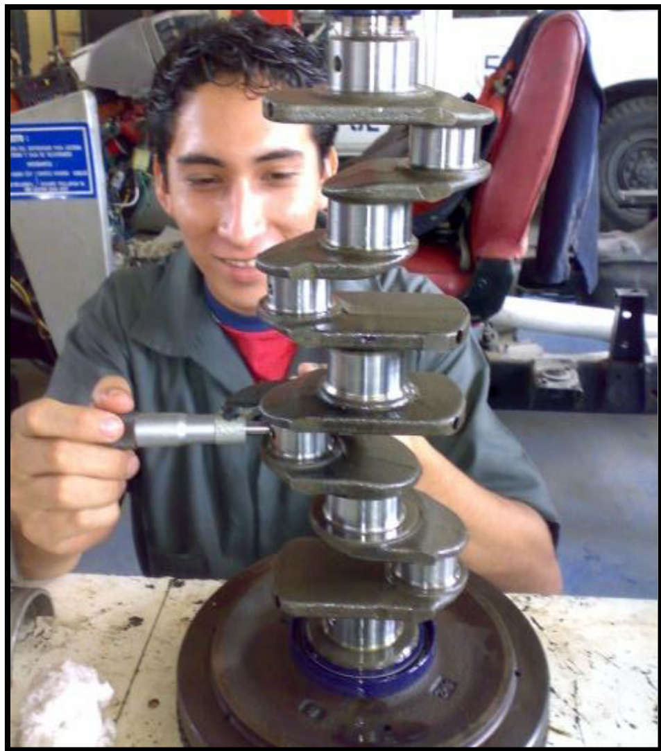
Fig. 3.8: Medicion de la conicidad y Ovalamiento
