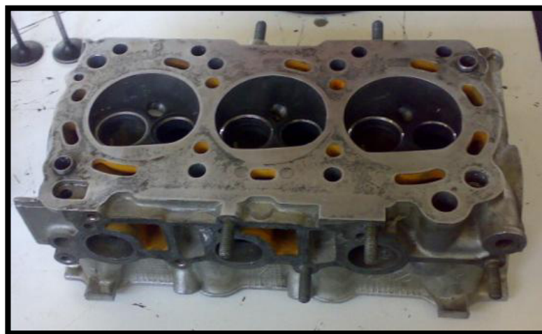
Fig. 3.12 Inspección Del Cabezote.
