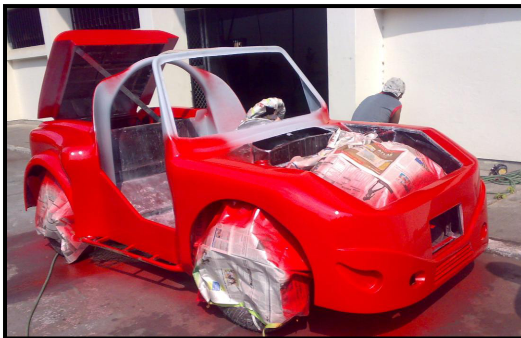
Fig. 9.10: Aplicación de Pintura Glasurit “Rojo Ferrari” primera capa
