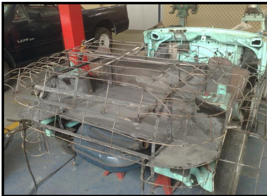
Fig.9.3: Elaboración de la estructura de la carrocería parte posterior
