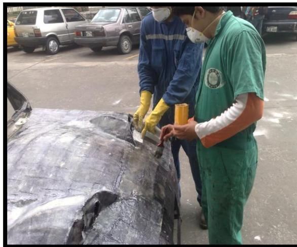
Fig. 6.5. Aplicación de la Resina y Fibra
