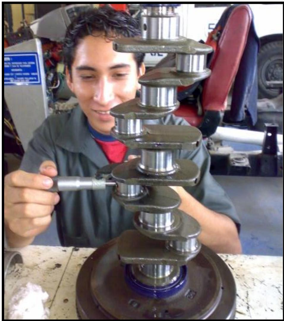
Fig. 3.8: Medicion de la conicidad y Ovalamiento
