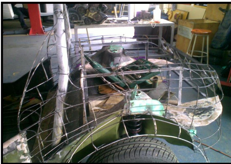
Fig. 9.5. Culminación de la estructura de la Carrocería
