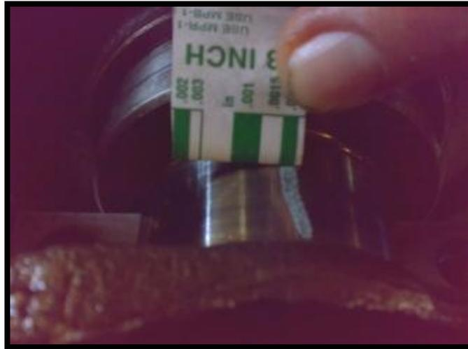
Fig. 3.9 Medición con Plastigage.
