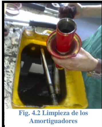
Fig. 4.2 Limpieza de los Amortiguadores
