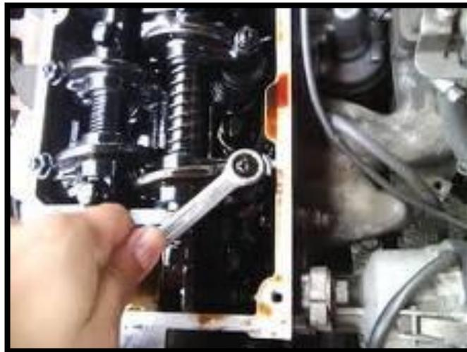
Fig. 3.18 Calibración de Válvulas.
