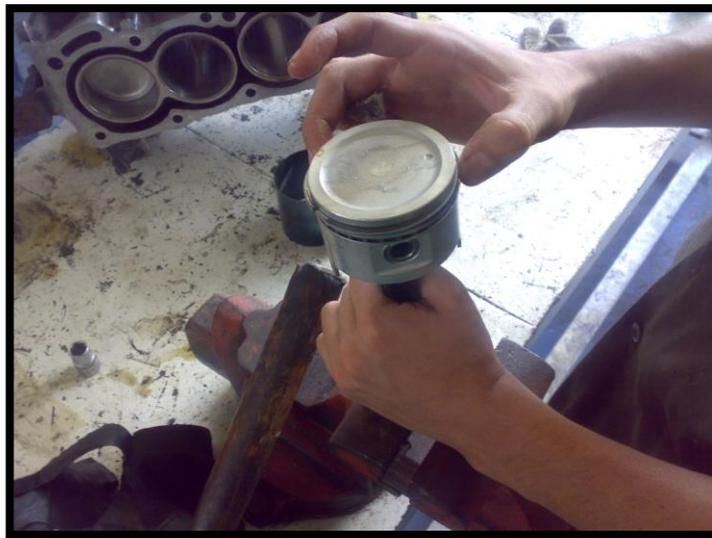
Fig.3.6 Medición de los Pistones.
