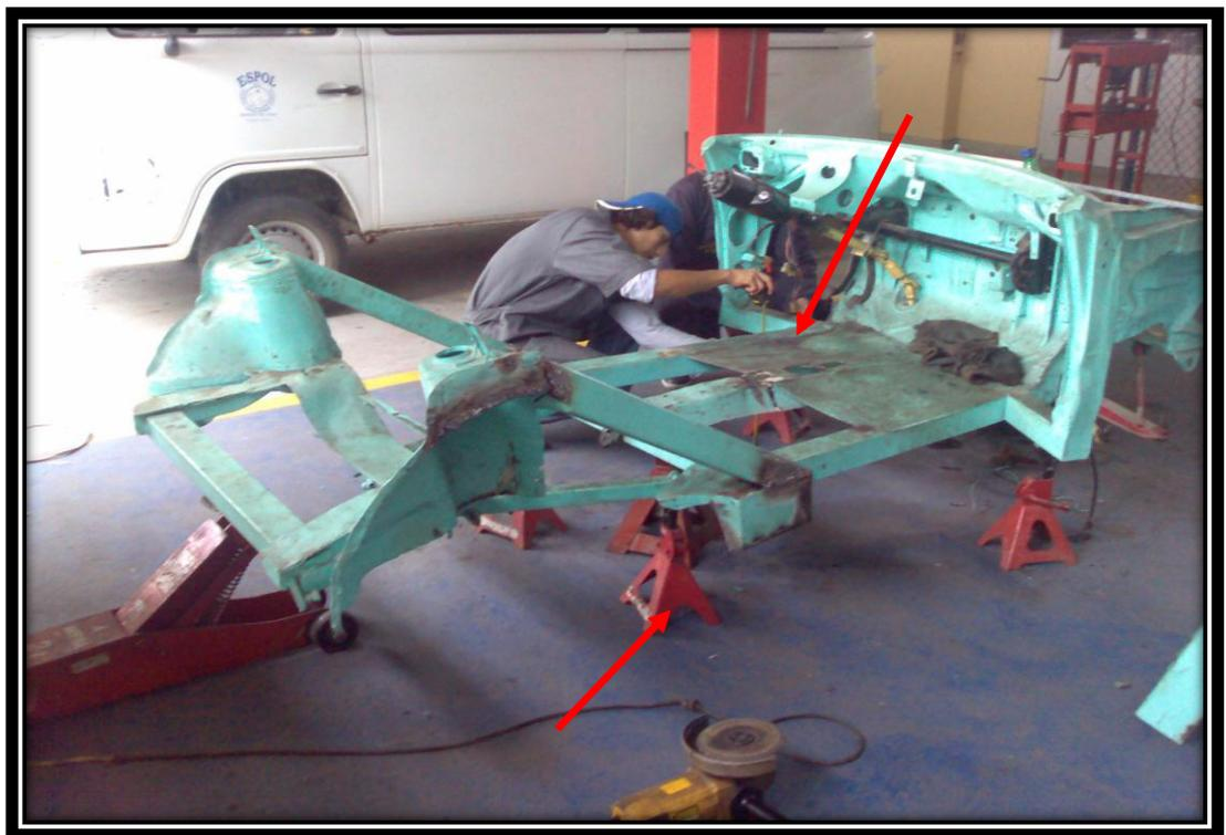
Fig. 2.1 Puntos de Anclaje
