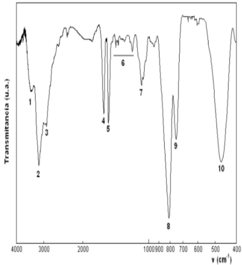
**FIGURA (2.11) ESPECTRO DE IR DEL COMPUESTO. [5].**
