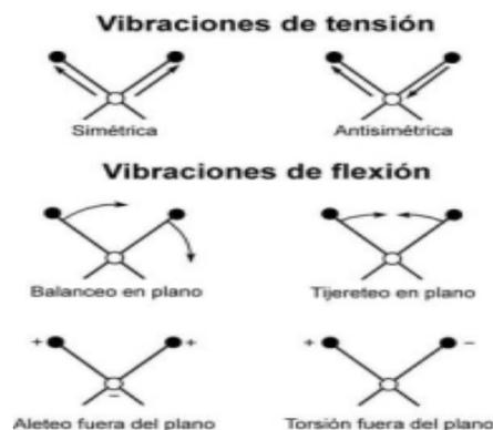
**FIGURA (2.10) DIFERENTES TIPOS DE VIBRACIONES MOLECULARES. [5].**
