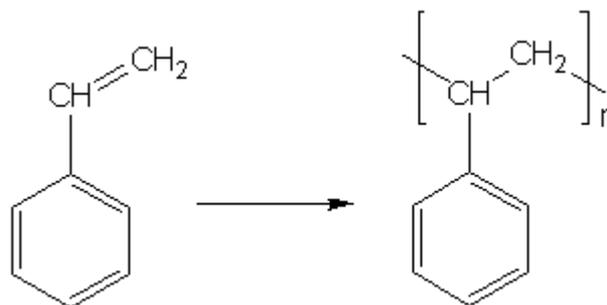
**FIGURA (2. 2) POLIMERIZACIÓN DEL ESTIRENO PARA DAR POLIESTIRENO N INDICA EL GRADO DE POLIMERIZACIÓN. [3].**
