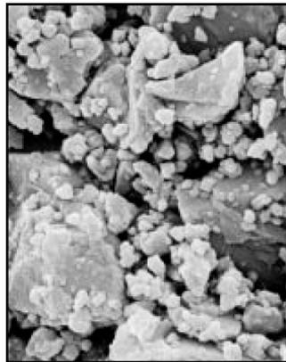
**FIGURA (2.23) MICROESTRUCTURA DEL CARBONATO DE CALCIO.**
