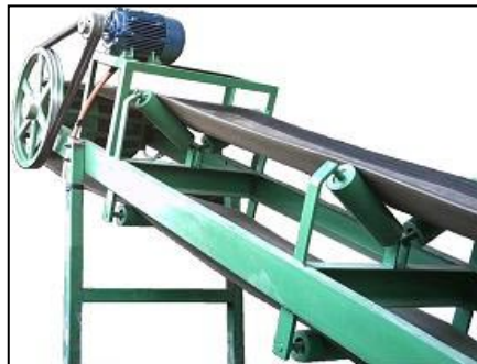
Figura 4.0.10: Conjunto de Tracción de la Banda Transportadora
