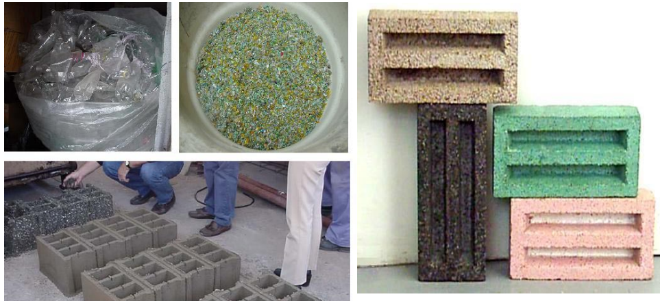
Figura 1.0.5: Ladrillos con Polietileno
