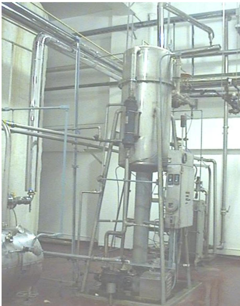
**FIGURA 1.4 TORRE DESAIREADORA DE AGUA DECLORADA.**
