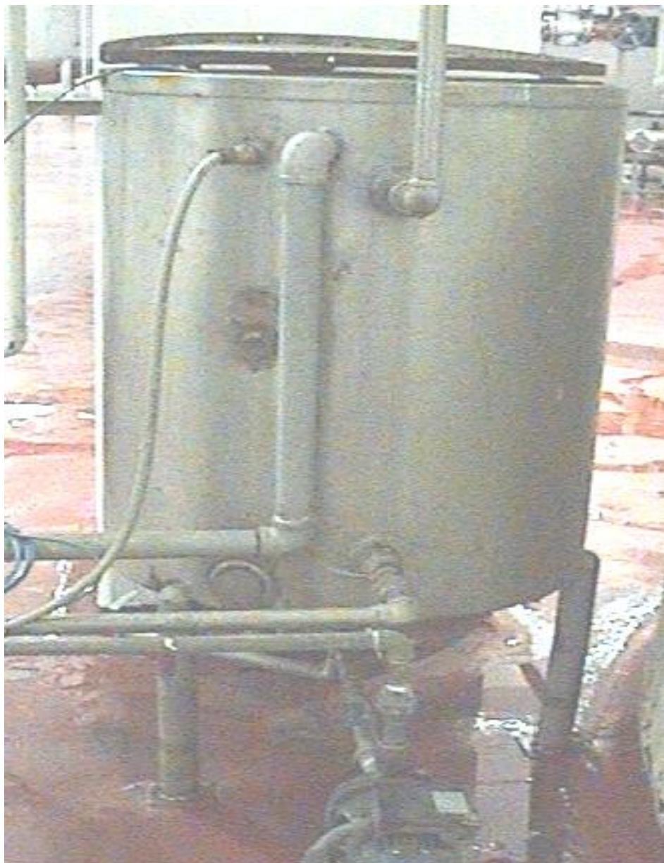
**FIGURA 2.5 TANQUE DE AGUA PARA RECIRCULACIÓN.**
