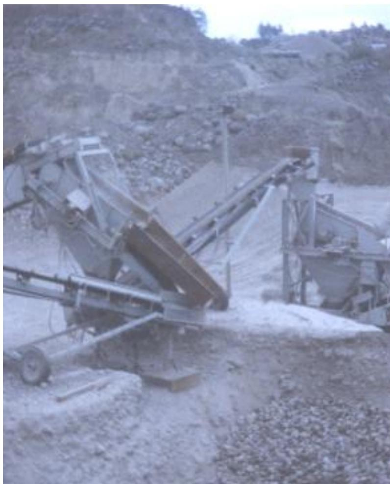
**FIGURA 1.4 CRIBAS VIBRATORIAS**
