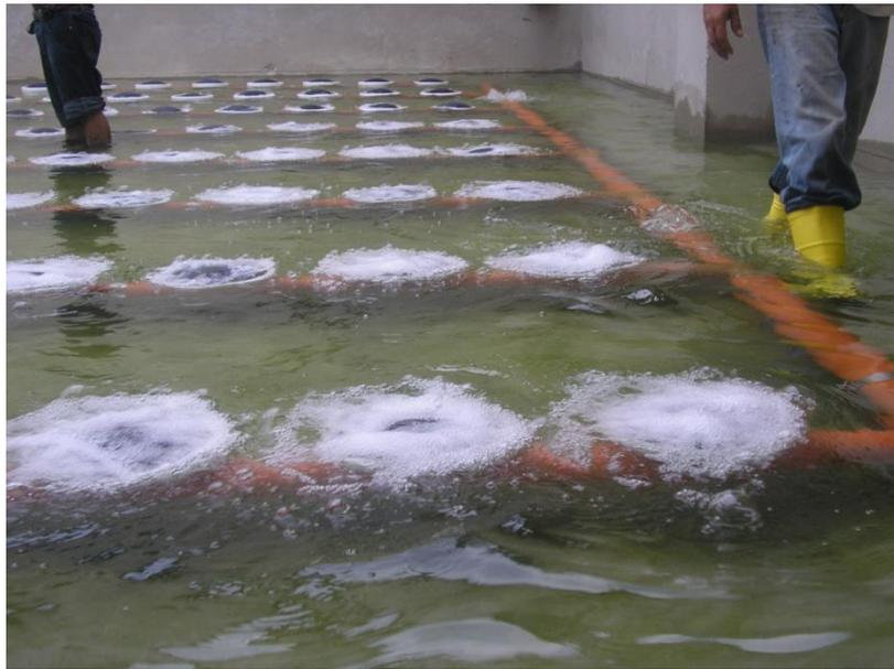
Prueba de Difusores en Tanque de Aireación
