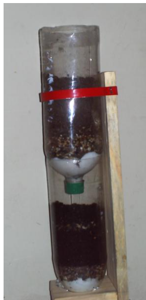
Figura 3.7 Sistema de Filtrado.
