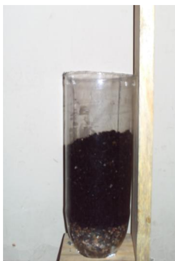
Figura 3.6 Filtro de Carbón Activado.
